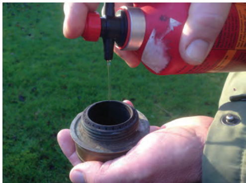
Når der trykkes på den 'røde knap' kan der løbe sprit ud af flasken
