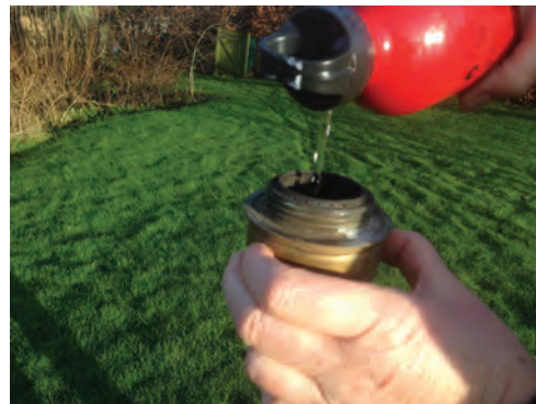
Spritten kan hældes i brænderen UDEN proppen er skruet af flasken. Selvom spritten antændes, kan dampene i flasken ikke antændes og trække brændende sprit ud af flasken.
