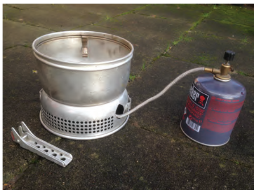
Trangia med gasbrænder og gasbeholder. Her skifter man hele gasbeholderen, når den er tom.
